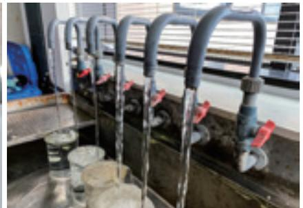
大野台浄水場では水づくりの工程ごとの水を採水し毎日検査を行います。
