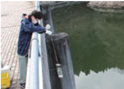
ダムの水質は季節により変動するため、計画的に水質検査を行い、水質の変化に応じた浄水処理に活かします。
